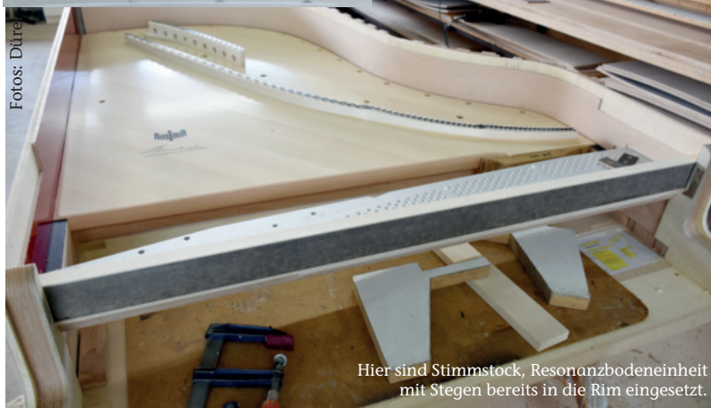
Eine Einheit: Der Resonanzboden, der bereits auf dem Bodenlager aufgebracht und berippt wurde, und die recht gerade geführten Stege.
